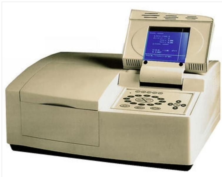
**Спектрофотометр СФ-104** — сканирующий спектрофотометр, работающий в УФ и видимой областях спектра. Оптическая схема с разделением светового потока позволяет учесть флуктуации и дрейф интенсивности излучения источника света. Встроенное программное обеспечение и большой дисплей позволяют работать без использования ПК.
