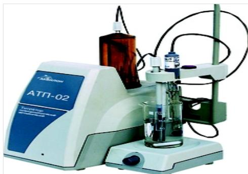
АТП-02 – автоматический высокоточный потенциометрический титратор. Прибор отвечает всем требованиям, предъявляемым к данному классу оборудования: непрерывная и дискретная подача титранта (диапазон от 0,1 до 36 мл/мин – при объеме дозирующего устройства 20мл; и от 0,25 до 90 мл/мин – при объеме дозирующего устройства 50мл), автоматическое изменение скорости подачи по мере приближения к точке эквивалентности или заданной точке и т.д.
